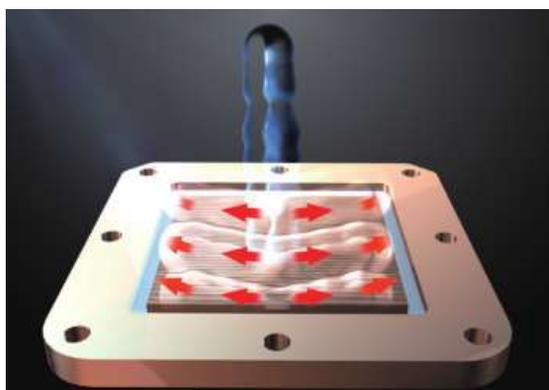
Design breveté Shunt-Channel Technology de la plaque froide pour une performance de refroidissement maximale. La CCI permet au liquide de refroidissement d'être injecté directement sur le point le plus chaud, évitant ainsi les risques de surchauffe et accélérant le transfert de chaleur.
